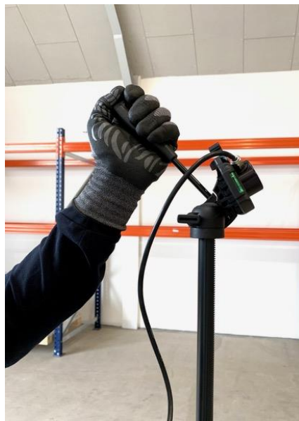
Figur 8: Eksempler på forskellige sensor-retninger ved indmåling for at lokalisere hotspots.
