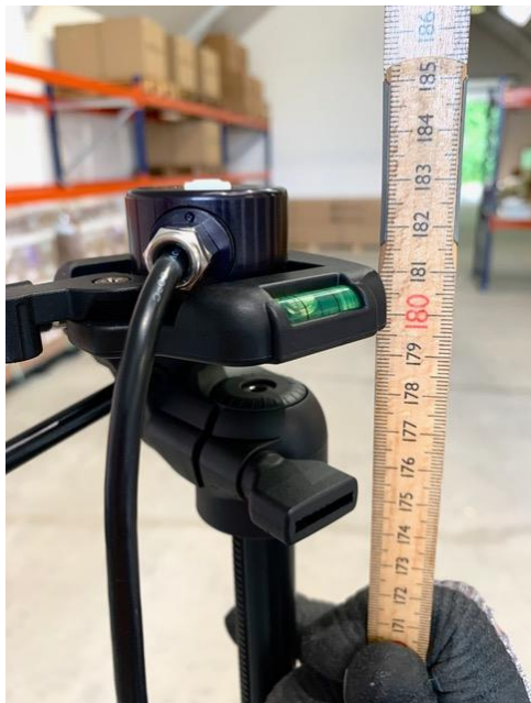
Figur 7: Indstilling af højde på sensorhoved til standard 183 cm eller acceptabel højde for de opgaver, der finder sted i rummet.
