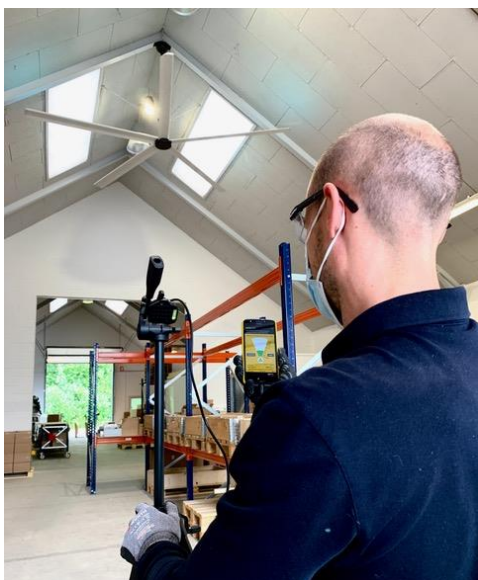
Figur 7: Indstilling af højde på sensorhoved til standard 183 cm eller acceptabel højde for de opgaver, der finder sted i rummet.
