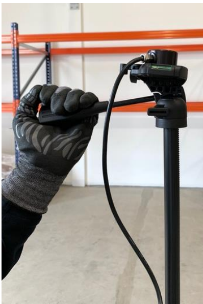
Figur 8: Eksempler på forskellige sensor-retninger ved indmåling for at lokalisere hotspots.
