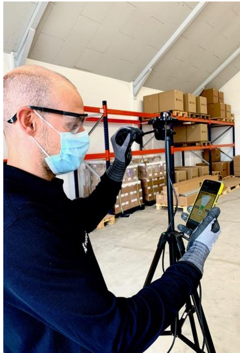
Figur 6: Indmåling af stråling i gitterpunkt
