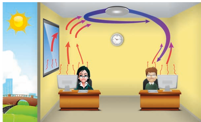
Figur 2. Renheden af indåndet luft og termisk komfort for de to personer afhænger af samspillet mellem luftstrømme, som er vanskeligt at kontrollere i rum med opblandingsventilation (Melikov 2016).
