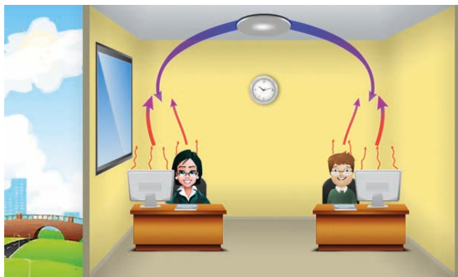
Figur 2. Renheden af indåndet luft og termisk komfort for de to personer afhænger af samspillet mellem luftstrømme, som er vanskeligt at kontrollere i rum med opblandingsventilation (Melikov 2016).
