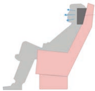
Figur 3. Sædeintegreret personlig ventilation (Bolashikov et al. 2010, Melikov et al. 2012).
